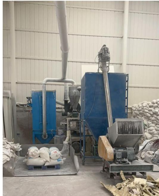
破碎工序脉冲除尘器
