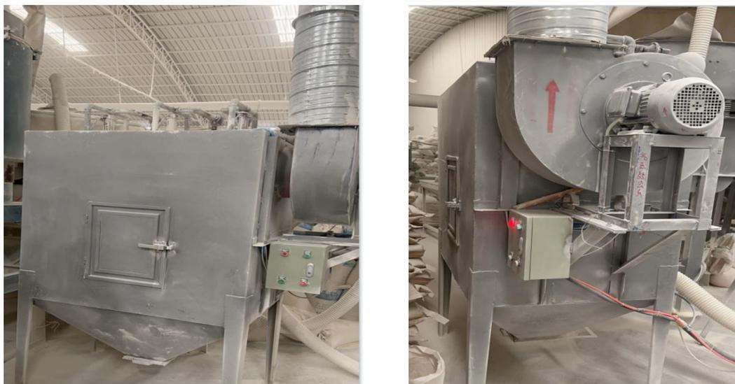
混料工序脉冲除尘器
