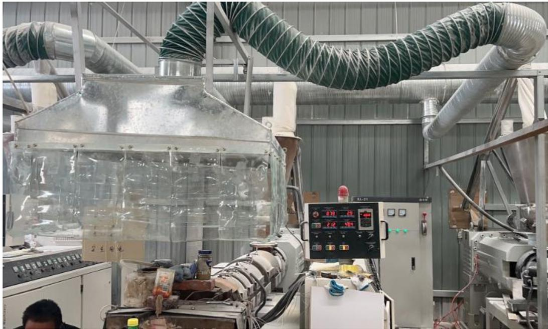
挤出工序集气罩+集气管道
