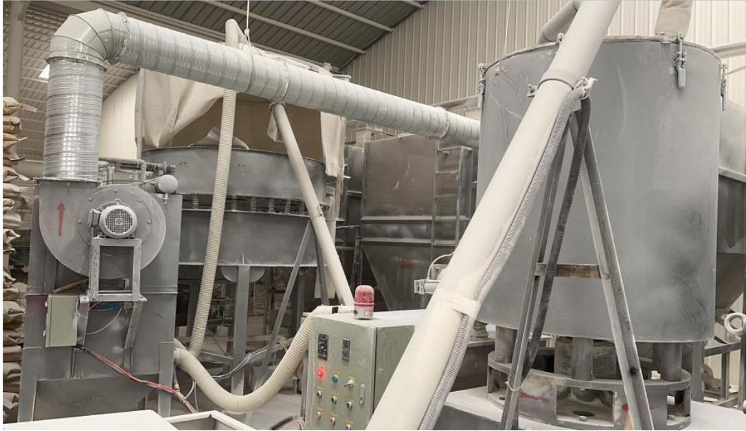
密闭集气管道+脉冲除尘器
